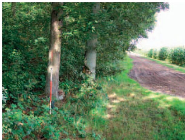
FIGUUR 2.2 PEILBUIS (TE) DICHT OP BOOM GEPLAATST (BRON: GROBBE, T. WATERSCHAP VOLT EN VECHT).
