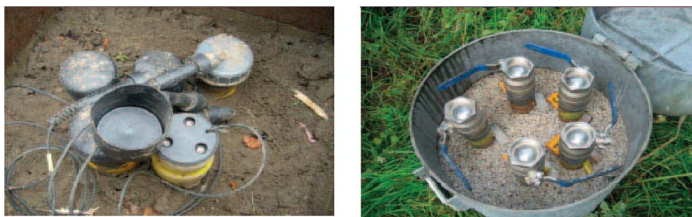
FIGUUR 3.5 PEILBUIZEN AFGEWERKT MET BEVEILIGDE DOP EN WATERDICHTE KAP (LINKS) EN MET KOGELKRAAN (RECHTS) (BRON: LEUNK, I. E.A., 2011)
