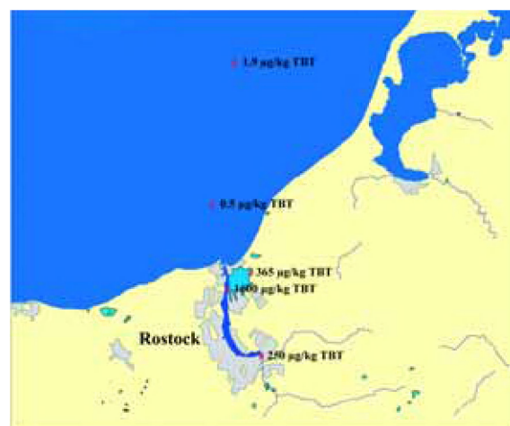
Abb. 8: Mediane der TBT-Konzentrationen in Sedimenten an den Messstationen der Warnowmündung (1999 - 2002)
