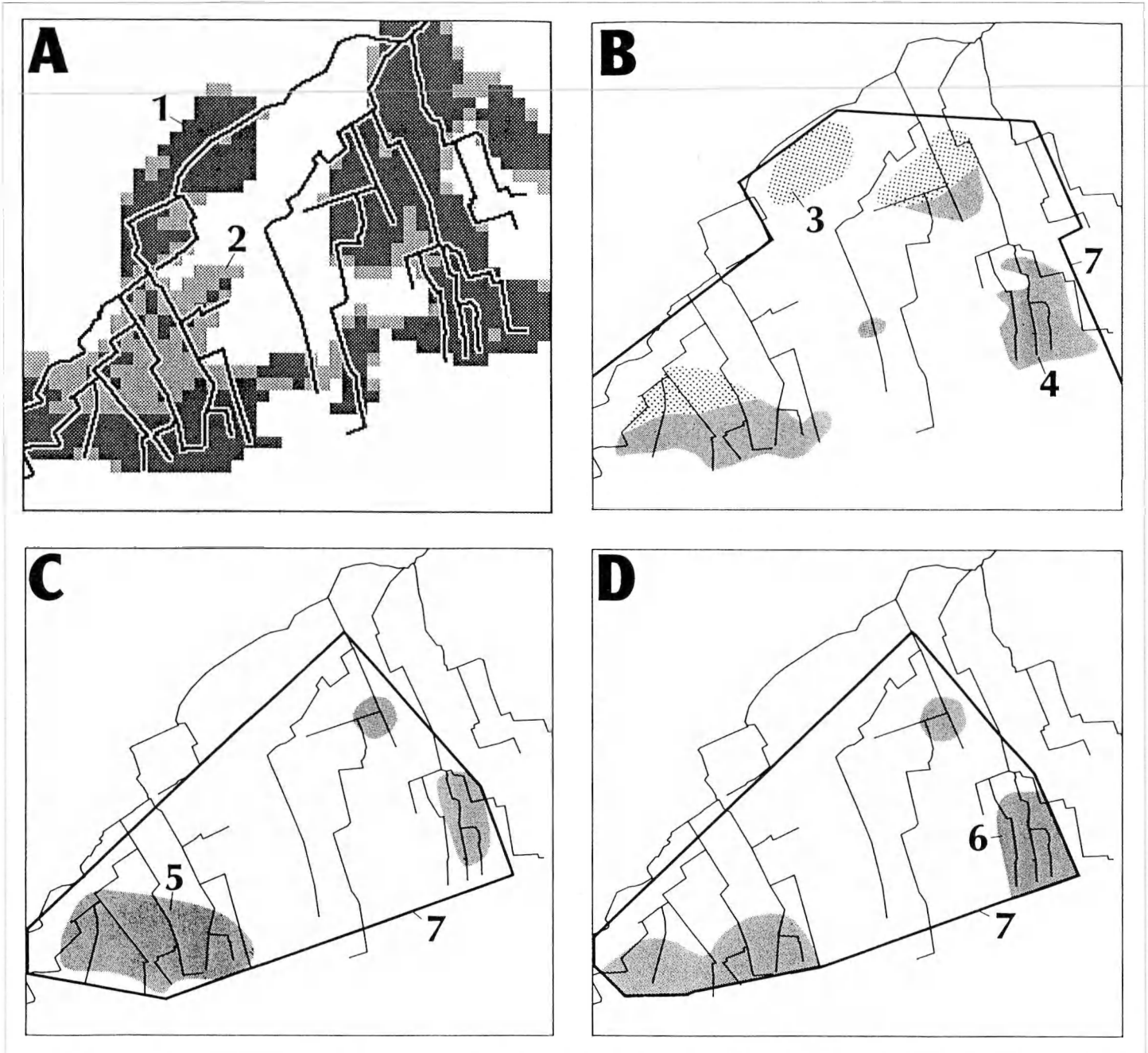
Fig. 7a : Gesimuleerde infiltratie en kwelgebieden in het Walenbos (1 : hoge kwel, 2 : lage kwel) 7b : Gekarteerd kwelgevoelige vegetatie (3 : basisch type, 4 : zuur type) 7c : Deel van Walenbos met waterpeilschommeling kleiner dan 40 cm (5) 7d : Gebieden met stijghoogteverschillen die wijzen op de aanwezigheid van opkwellend grondwater (6) Begrenzing terreinwaarnemingen (7)
