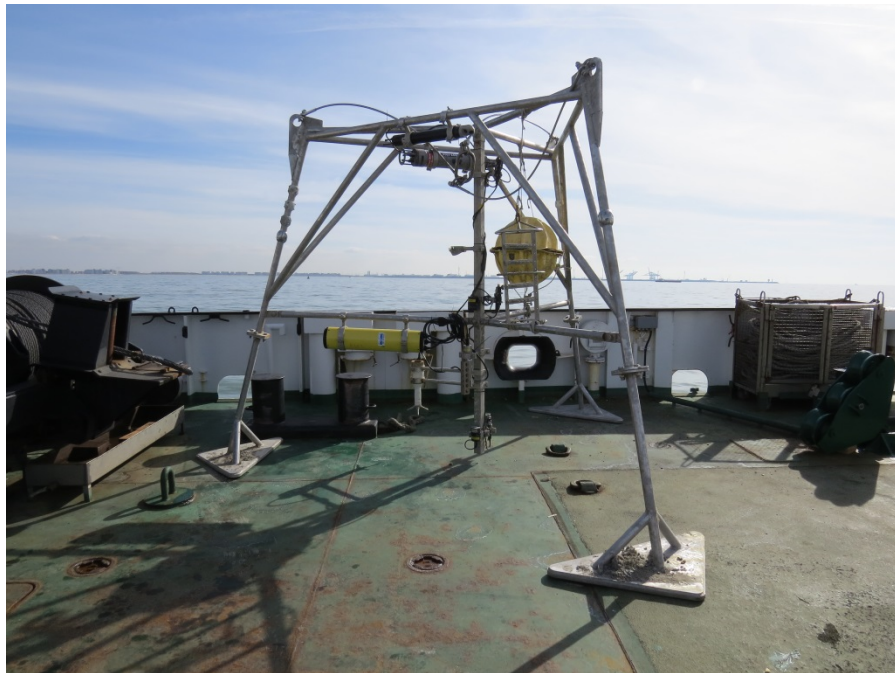
Foto 2. Tripode voorzien van SonTek ADV en ADP, 2 SonTek Hydra, SBE37, 2 OBS en LISST-100X
