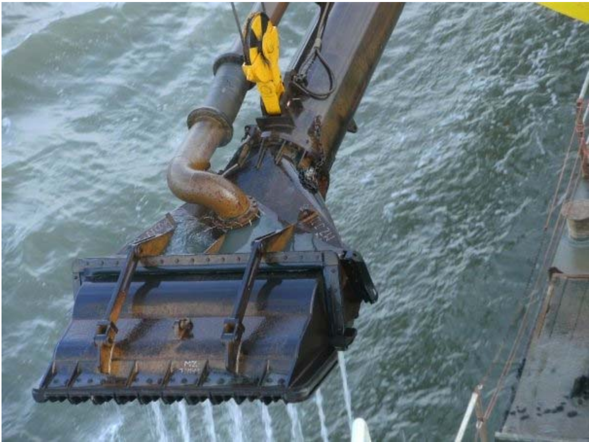
Figuur 11 - Sleepkop van een sleephopperzuiger. Foto door Charlotte Dhollander.
