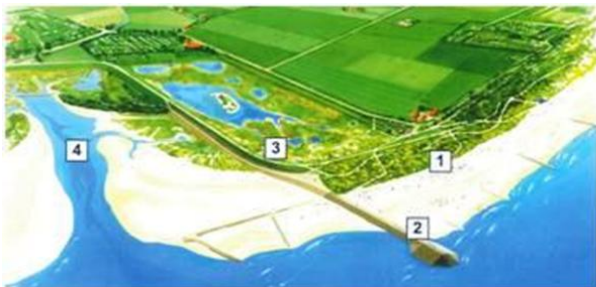
Figuur 4.11 Voorbeeld van 'duin-voor-dijk' concept voor de Herdijkte Zwarte Polder. De nieuwe situatie na versterking is schetsmatig weergegeven in de onderstaande figuur. Hierin verwijst (1) naar de extra strook zand en duinen en (2) naar de aangepaste strekdam. Hiervoor is het meest oostelijke strandhoofd op de kop van de Herdijkte Zwarte Polder (3) gebruikt. Teneinde te voorkomen dat bij een maatgevende storm het zand niet oostelijk in de richting van de Verdrongen Zwarte Polder (4) verdwijnt, is dit strandhoofd opgewaardeerd tot een voldoende hoge strekdam die qua sterkte ook bestand is tegen de maatgevende ontwerpondercondities.
