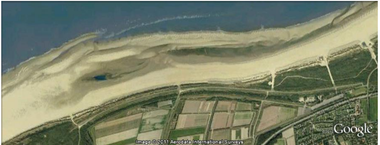
Figuur 4.13 Voorbeeld van het 'hard-blijft-hard' concept bij het Flaauwe Werk. Het betreft een asfaltglooiing welke aan beide zijden overgaat in een zandige duin.
