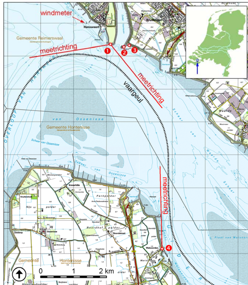
Figuur 2-4. Meetlocaties Hansweert, gemarkeerd met 1, 2 en 3, en Walsvoorden, gemarkeerd met 4. Voor locatie 1 en 4 zijn de meetrichtingen weergegeven. Windmeter: meetpaal van Rijkswaterstaat waar windsnelheid, windrichting en waterhoogte gemeten worden.
