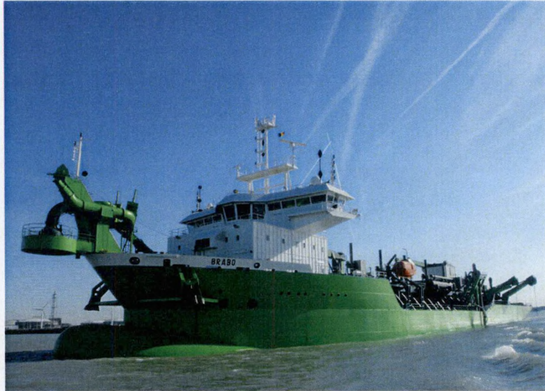
Foto 3. TSHD BRABO - Hopper capacity 11.650m 3 - DWT 18.565 MT Dredging depth 28 - 43 m. Bouwjaar 2007 Baggerbedrijf DEME nv. Zwijndrecht.
