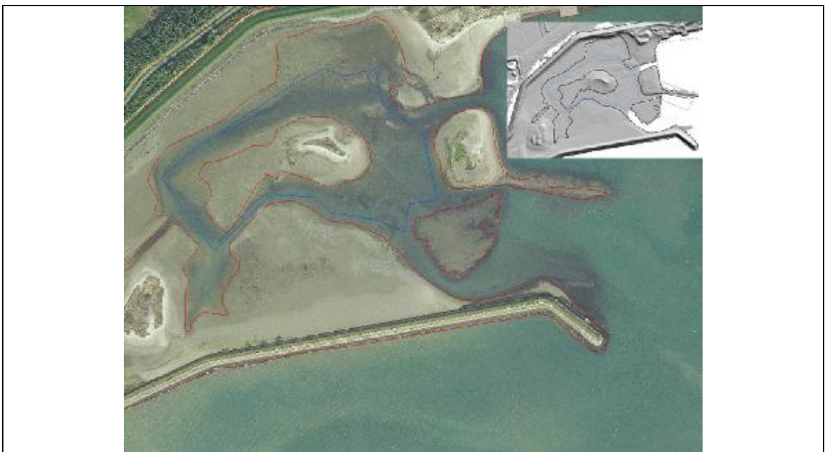
Figuur 3.7: Voorbeeld van een filtering. Op de gefilterde hillshade (zie inzet) is goed te zien dat het water in de Oosterschelde is uitgefilterd. In het blauwomlijnde gebied zal mogelijk ook water te vinden zijn, maar dit is niet uitgefilterd. De waterlijn is hier moeilijk te bepalen.
