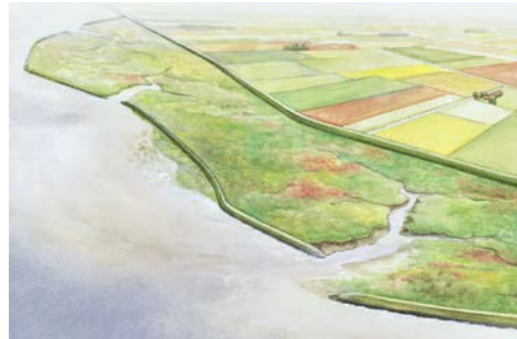
Schorbuffers: herstel van schor door landinwaartse verlegging van de zeedijk
