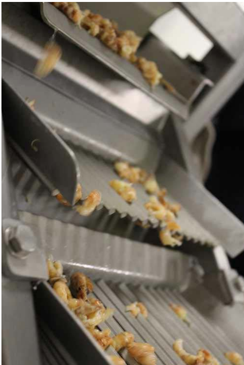
Close-up van een garnaalpelmachine - © VLIZ, Fien De Raedemaecker
