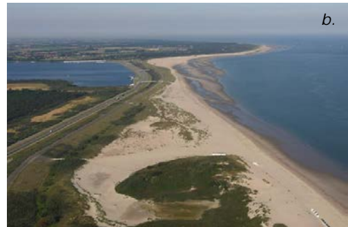
Figuur 14, a. Een voorbeeld van "Dijk in Duin" ontwikkeld door het Hoogheemraadschap van Rijnland (2007) als oplossing voor een zwakke plek in de zeewering b. De Veerse Gat dam (1961) die door transport van zand geleidelijk aan een duin is geworden.
