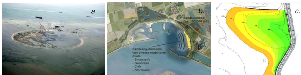
Figuur 12, a. suppletie Galgenplaat in uitvoering. b. Proef bij de Schelpenhoek waarbij het effect van drempels op het behoud van een suppletie wordt onderzocht (Tauw 2008) c. suppletie Oesterdam
