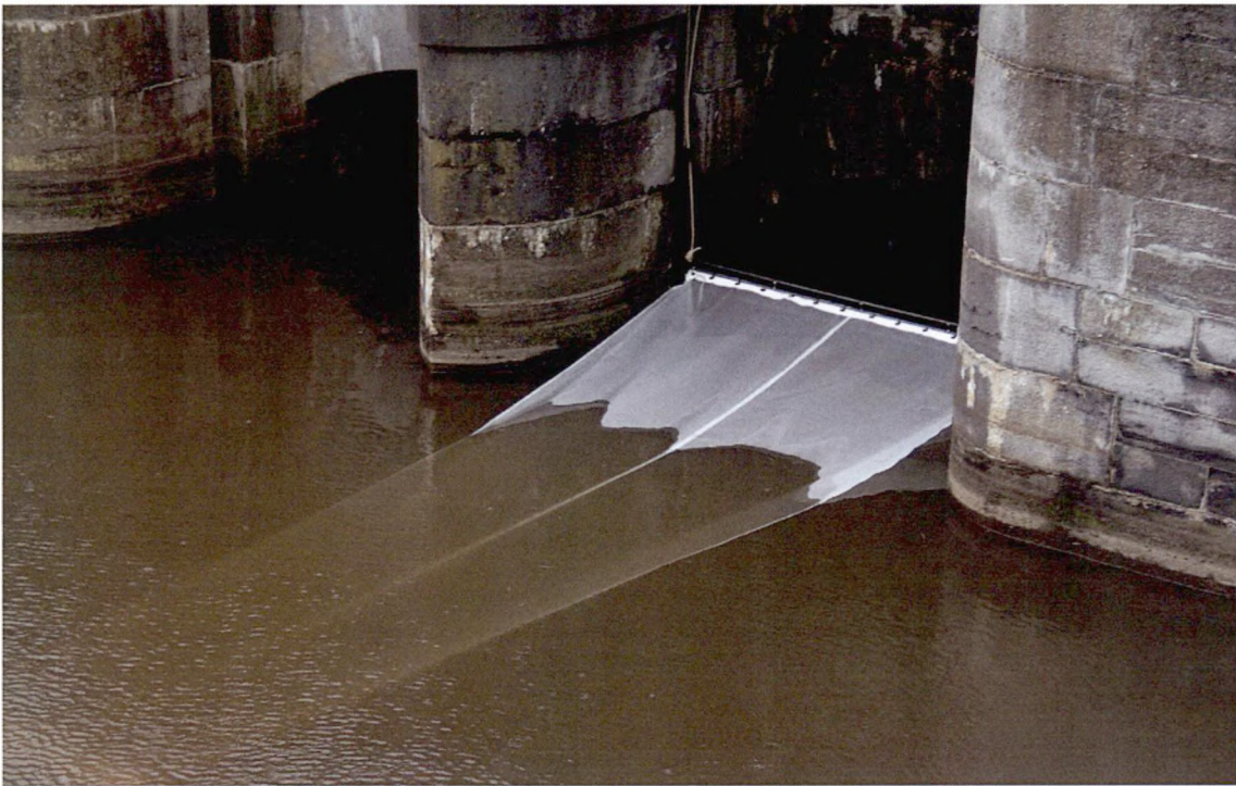
Fig. 5. Plaatsing van de fuik in een spui-opening van de IJzer, stroomopwaarts van het spuicomplex.
