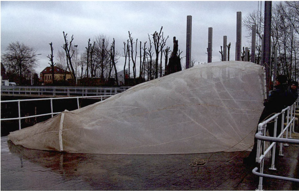
Fig. 4. De fuik waarmee stroomopwaarts migrerende glasaal bemonsterd werd.
