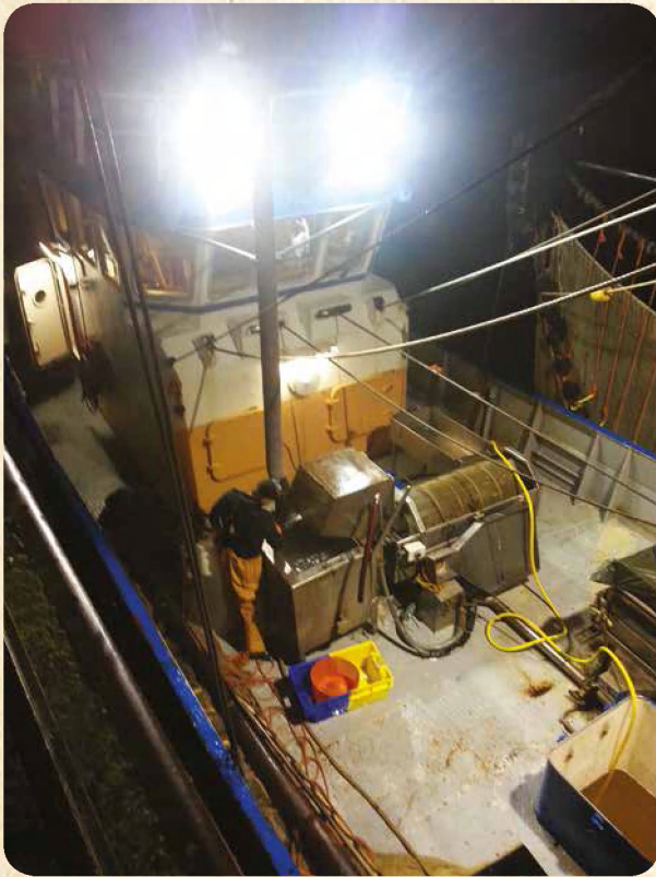
Fig. 6 Voorbeeld van een huidige kookketel met uitkipsysteem voor het overbrengen van de garnalen in de koeltrommel (Foto: ILVO © Xavier Vermeersch).
