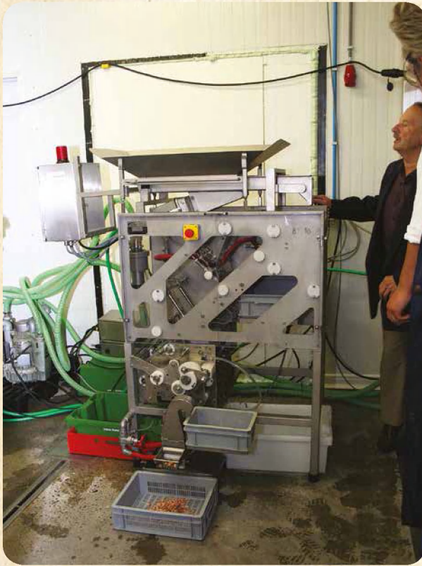
Fig. 9 Een voorbeeld van een moderne garnalpelmachine, voor het automatisch pellen van grijze garnalen (Foto: Nature and species of Belgian coast / Fockedey, Nancy, 2008).
