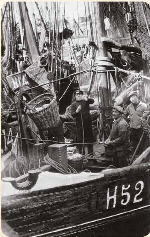
Fig. 3 H52 lost zijn vis te Zeebrugge. Houten vissersvaartuig, gebouwd 1927 scheepswerf 'Denye', Kromhout motor 80 PK. Ooit strandde dit vaartuig op het strand te Heist in een mistbank schipper reder: Frans Gezelle, lapnaam 'Rattens' (Bron: Sincfala beeldbank, VLIZ vloot databank).
