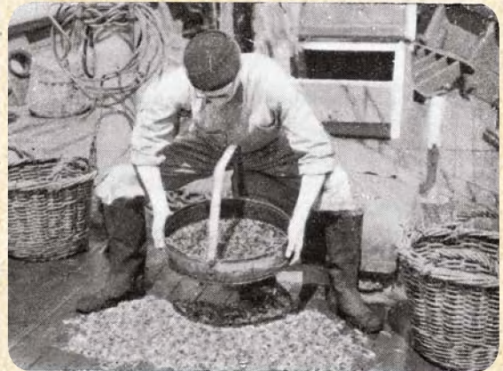
Fig. 3 De krabben- en garnalenzeef, voor het manueel sorteren van de vangst en het scheiden van de garnalen van de bijvangst (Foto's: Hovart et al., 1960).
