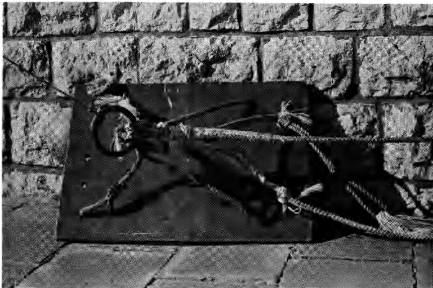
Figuur 7 - Bevestiging van het net aan het scheerbordje.
