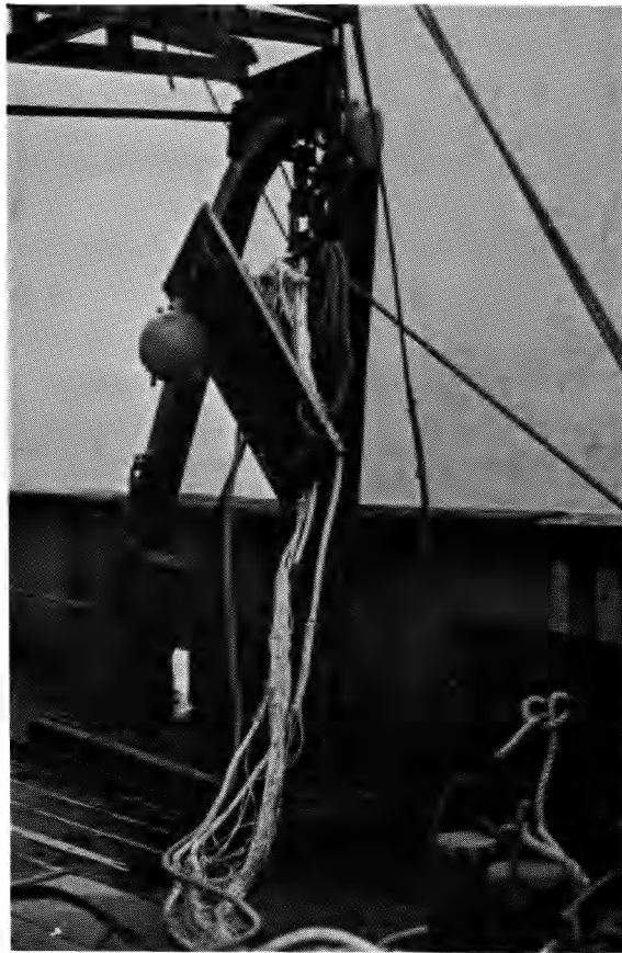
Figuur 6 - Bevestiging van vlotter aan het scheerbordje.
