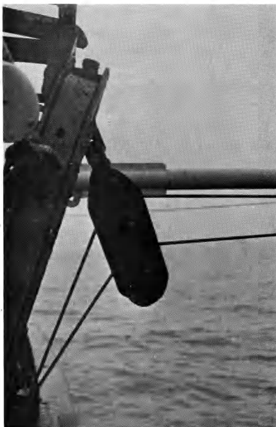
Figuur 3 - Dubbel blok dat de vislijnen splitst al- vorens zij naar de top van de bok gaan.
