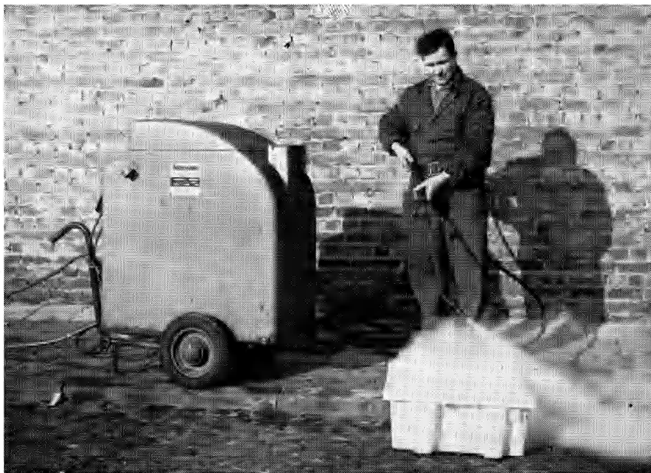
Fig. 3. — Stoomreinigen met automatische detergentoevoer
