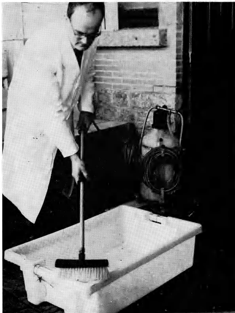
Fig. 1. — Borstelrichting met automatische detergentoevoer
