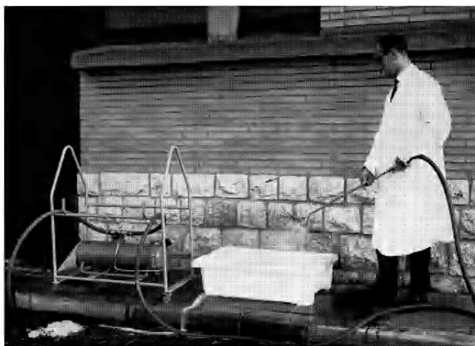
Fig. 4. — Desinfektie-apparaat met automatische toevoer en drukregeling
