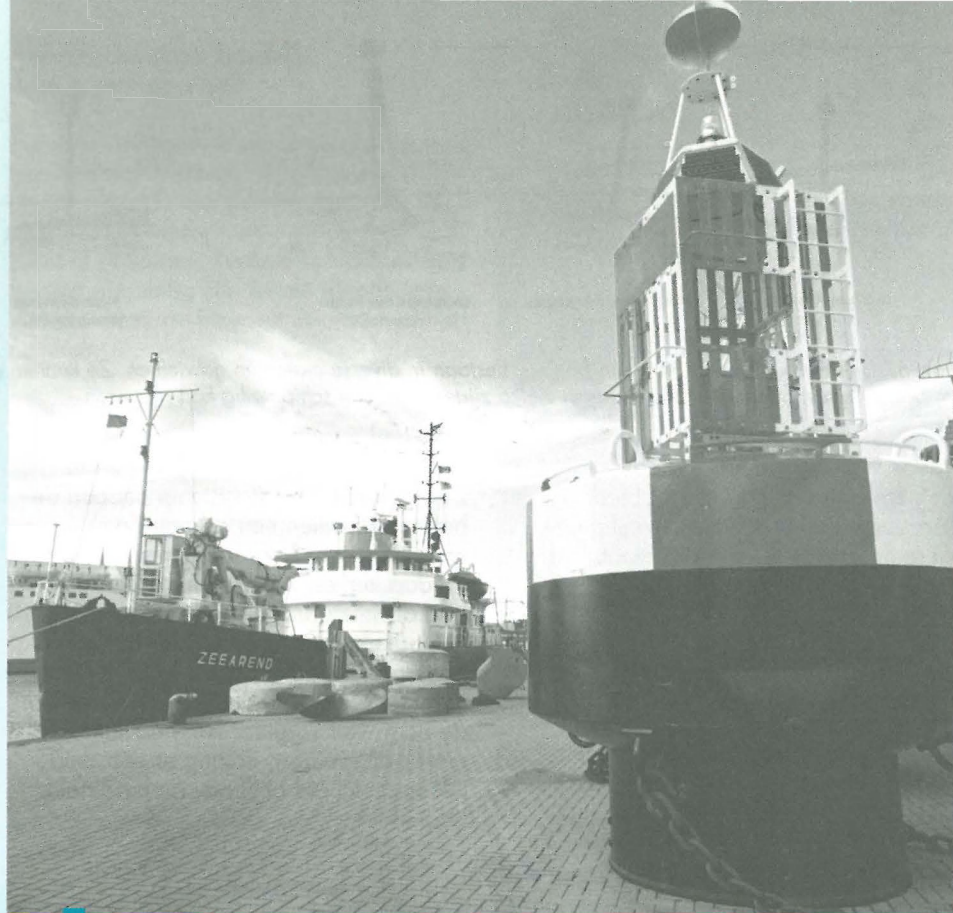
DAB Vloot zet voor het beboeien en bebakenen in de Belgische territoriale wateren de 'Zeearend' in. De Zeearend is voorzien van een werkjool om personeel naar en van de boeien te brengen voor kleine reparaties, en is het enige vaartuig aan de kust dat geschikt is om op een efficiënte wijze boeien op te nemen en uit te zetten d.m.v. zijn kraan
