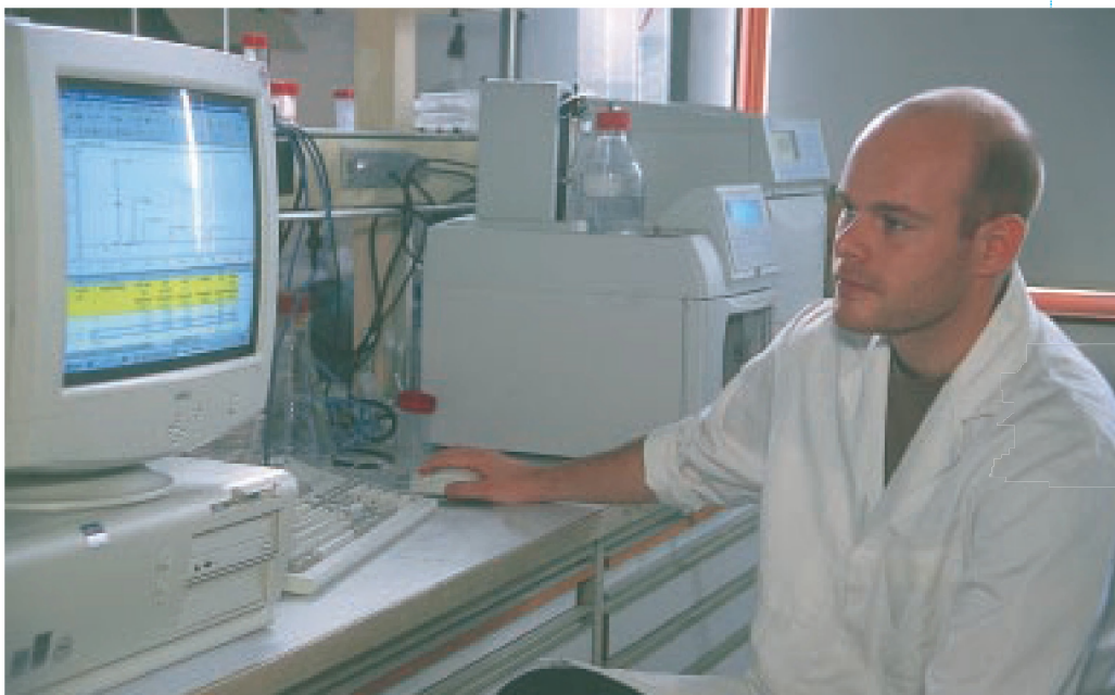
Kurt Eyckmans onderzoekt de samenstelling van een bulkstaal met behulp van een ionenchromatograaf (MD)
