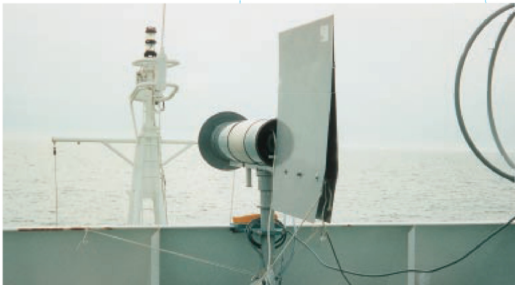
Het nemen van stalen van aërosolen op zee. Via een windtunnel wordt lucht aangezogen. De windhaan achteraan zorgt ervoor dat er steeds tegen de windrichting in bemonsterd wordt. In de buis kan een filterhouder of een impactor geïnstalleerd worden (MITAC)
