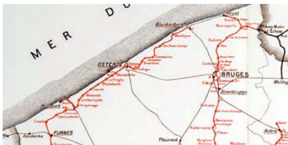
In 1912 was het stoomtramnetwerk in de kustprovincie gevoelig uitgebreid. Dé vernieuwing was echter de opkomst van de elektrische tram. Die opereerde in 1897 voor het eerst aan de kust op het stadsnet van Oostende (NMVB) en kort daarna tussen Oostende en Middelkerke. Al gauw zou de volledige kustlijn zijn eigen elektrische tramtraject kennen (collectie Centrale Bibliotheek Leuven)
