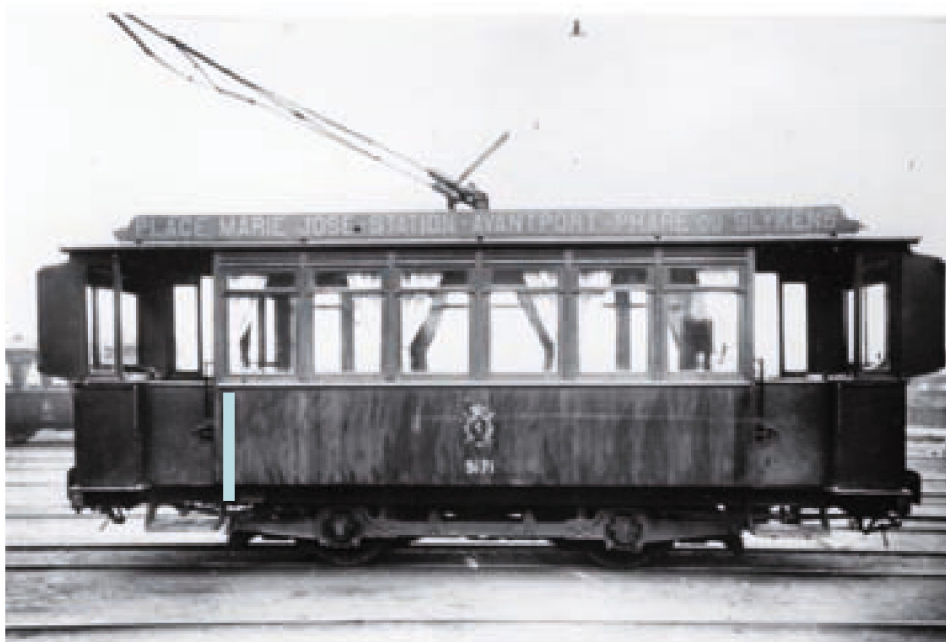
Deze foto uit 1919 toont een vroege elektrische tram 'Type Phare'. Dit type reed vanaf 1897 tussen Oostende en Middelkerke en verhuisde na de opkomst van de OB-tram naar het stadsnet van Oostende. Zijn naam dankte hij aan de eindhalte nabij de oude vuurtoren, gelegen t.h.v. het huidige 'Klein Strand' en het monument van de zeelieden (collectie Walter Weyts)
