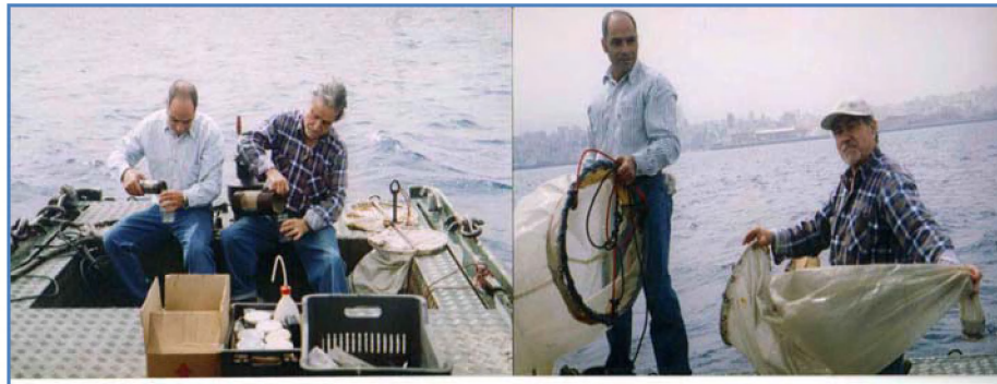
Fig. II.2a-Pêche du plancton au large de Byblos 15 Mars 1993 au bord d'une barque de pêche, utilisant 2 sortes de filets ; 1: Filets 52 µ et 200 µ de 1.20 cm de long et 40 cm de diamètre, couplés sur système Bongo. 2:Filet fermant de 75 cm de diamètre, maille 200 µ et 2.50 m de long.
