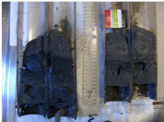
**Figure 8 :** Photo de deux coupes longitudinales d'un sédiment de type argileux prélevé à la station 130 en février 2007
