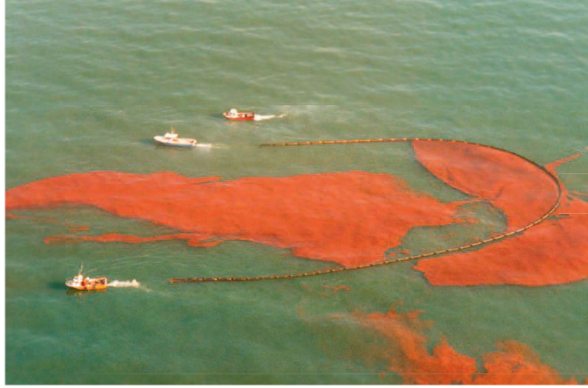
Deploying a boom to contain oil Mise en place d'un barrage pour contenir des hydrocarbures Einsatz von Sperren zur Eindämmung von Öl
