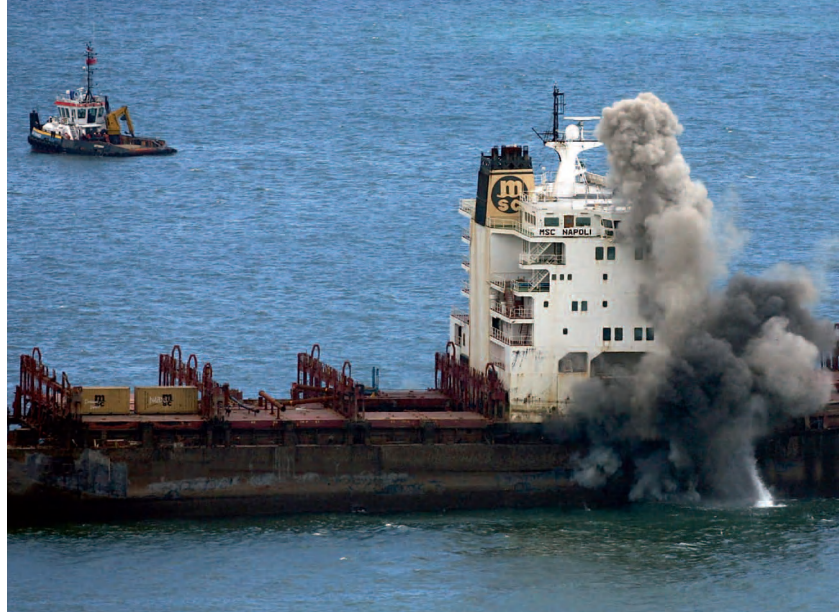
Breaking the MSC Napoli using explosives Utilisation d'explosifs pour sectionner le MSC Napoli Trennen der MSC Napoli mit Hilfe von Sprengstoff
