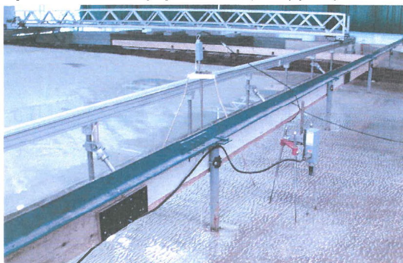
Figuur 4. Proeven in WLH-golftank voor ontwerp zandsuppletie te Knokke-Zoute
