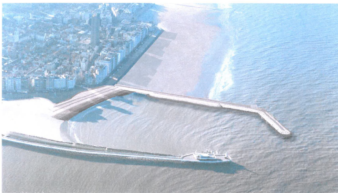
Figuur 1. Illustratie van ontwerp strand en aanzet westelijke havendam te Oostende
