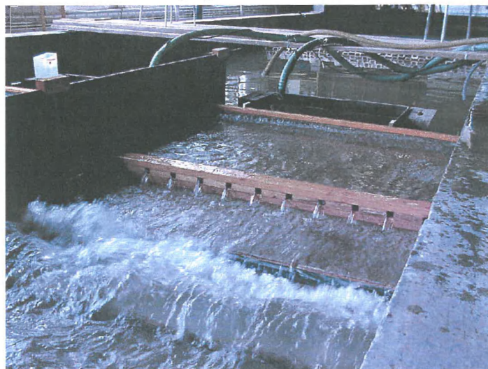
Figuur 3. Proeven in WLH-golfgoot voor ontwerp zeedijkvloeiing te Oostende
