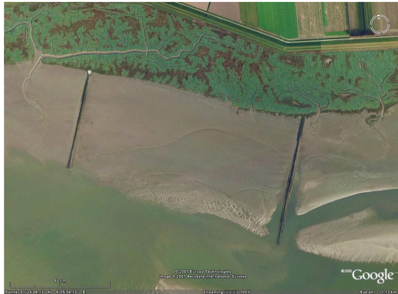
Figuur B4.26: Dwarsdammen in de slikken, om het Schor van Waarde tegen de verplaatsingen van de geul te beschermen (bron: Google Earth).
