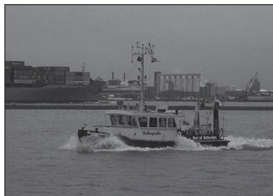
Multibeam survey vessel Dintelwerken.
