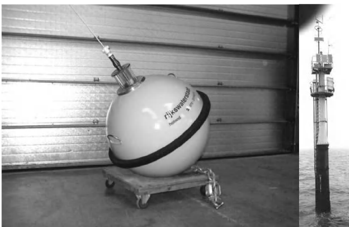
Fig. 2. Meetboei Deurloo (links) en Meetpaal Vlakte van de Raan (rechts) binnen het ZEGE Meetnet
