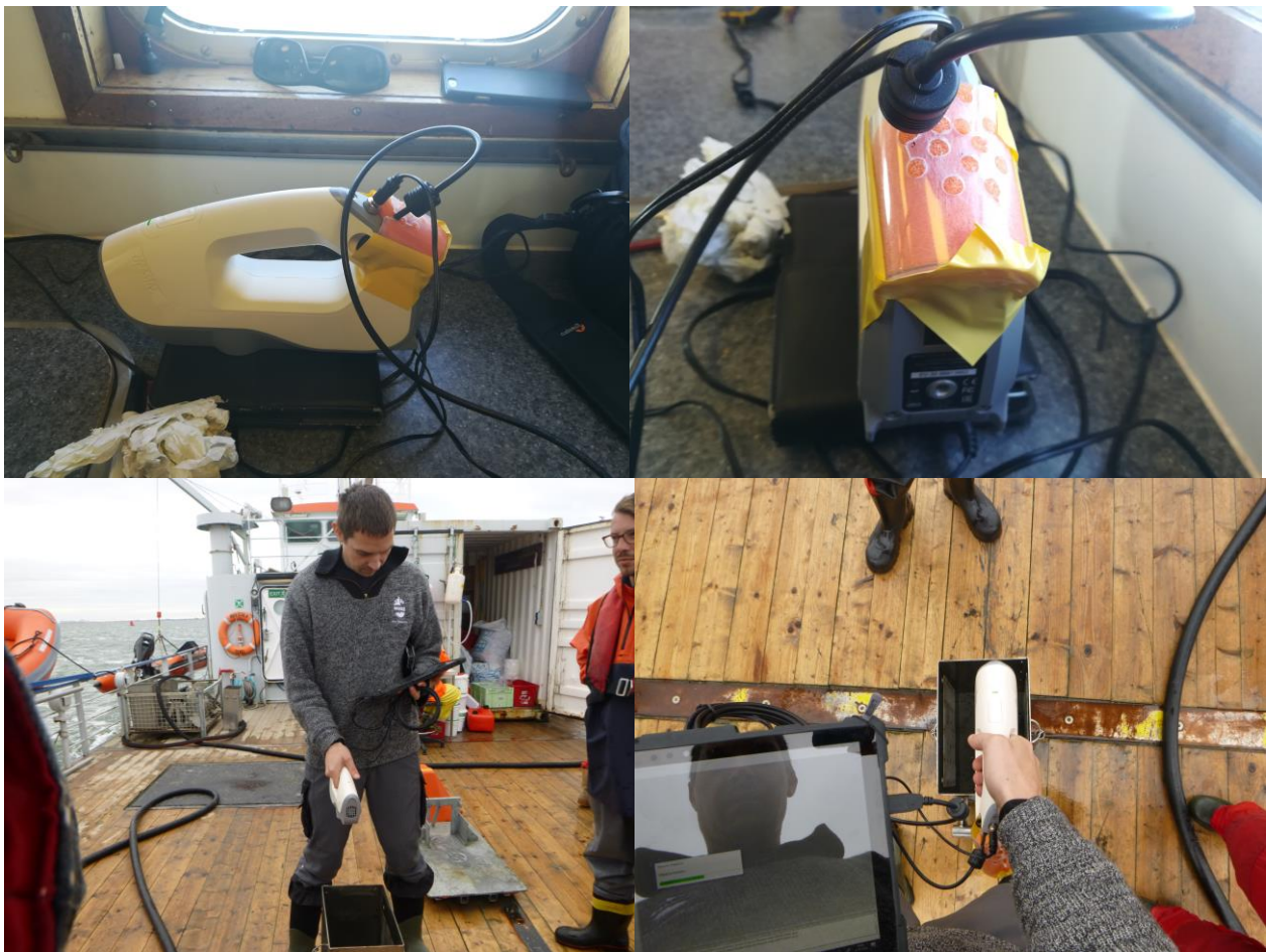
AFBEELDING 8. ARTEC EVA HAND-HELD 3D SCANNER EN DE SCANNER IN ACTIE.
