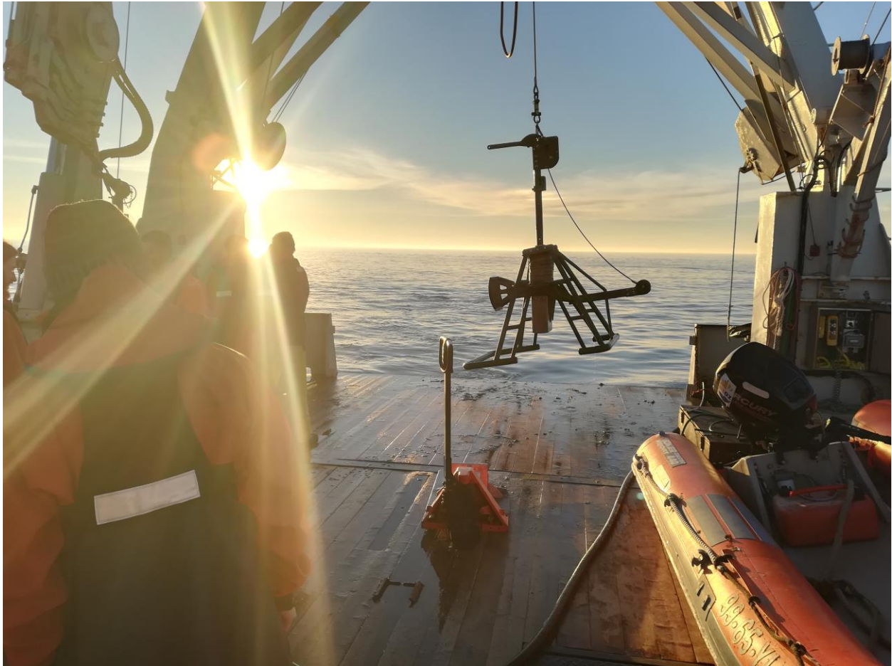
AFBEELDING 2. BOXCORE VANAF HET ACHTERDEK VAN DE NAVICULA
