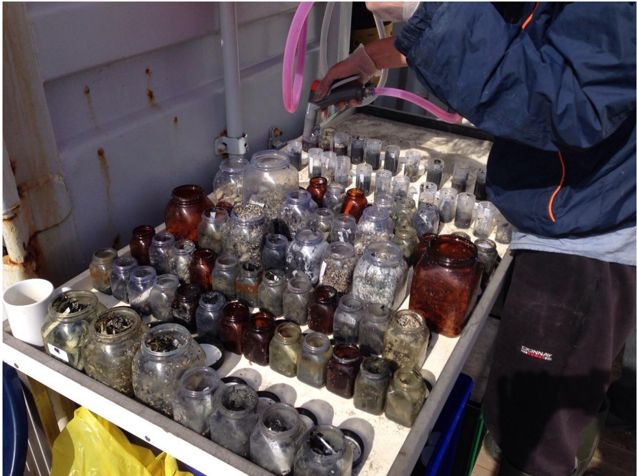
AFBEELDING 7. VULLEN VAN POTTEN MET FORMALDEHYDE OPLOSSING TER CONSERVERING VAN DE MONSTERS.
