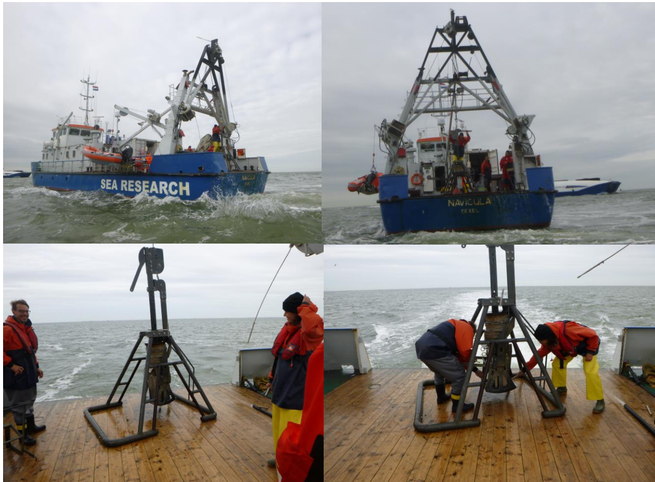
AFBEELDING 4. BOXCORE BEMONSTERING VANAF RV NAVICULA.
