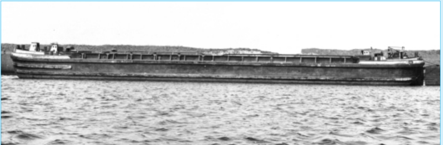
Zogenaamd 'klepbakship', gebruikt voor de dumpingsoperatie van oude WOI munitie vóór de Belgische kust. Zo werd gedurende een half jaar, van november 1919 tot mei 1920, dagelijks een scheepslading munitie (zo'n 340 ton) in zee gedumpt
