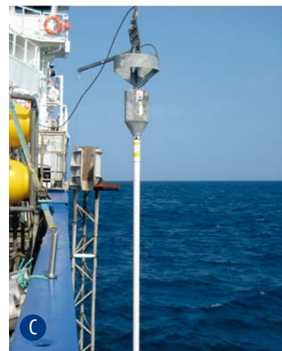
AFBEELDING 8. | Uitleg over de werking van bodembemonsteringsapparatuur. A) Boxcorer: Boven aan de boxcorer zit een hefboom met een gewicht. Wanneer het frame de zeebodem raakt ontspant de vergrendeling van het hefboompje waardoor de horizontale arm die de bodem onder de emmer trekt ontgrendeld wordt en bij het halen van de kabel de emmer kan sluiten. B) Multicorer: Wanneer de buizen weer uit de zeebodem getrokken worden sluiten armpjes met kleppen door middel van veren razendsnel de onderkant van de buizen af, zodat het sediment er niet meer uit valt. Vanwege de schaal kan dit mechaniek niet in de tekening opgenomen worden. C) Pistoncorer: Langs de buis van de pistoncorer hangt een lange kabel met een klein gewichtje. Zodra dit gewichtje de zeebodem raakt ontgrendelt de hefboom een mechaniek waardoor de pistoncorer een vrije val maakt (het vieren van de kabel door het schip wordt gestopt en het deel losse kabel komt vrij). Door de snelheid dringt de buis enkele meters de zeebodem in. De hijskabel staat strak zo gauw de punt van de buis de zeebodem raakt. De hijskabel loopt door tot het uiteinde van de buis. Aan het einde van deze kabel zit een zuiger ('piston' in het Engels). De buis zakt door, maar de zuiger staat stil. Er ontstaat dus een onderdruk in de buis, waardoor deze beter gevuld wordt met sediment.
