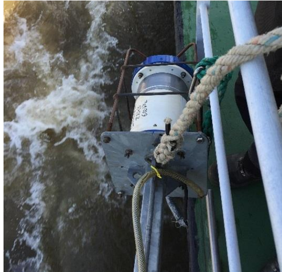
Figuur 2.10: De ADCP meetstelling op meetschip Scaldis I (meetdagen 2-3).
