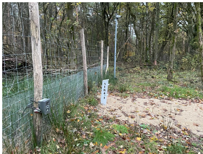
Figuur 2.2: Opstelling van lijndetectiesensor, cameraval en videocamera
