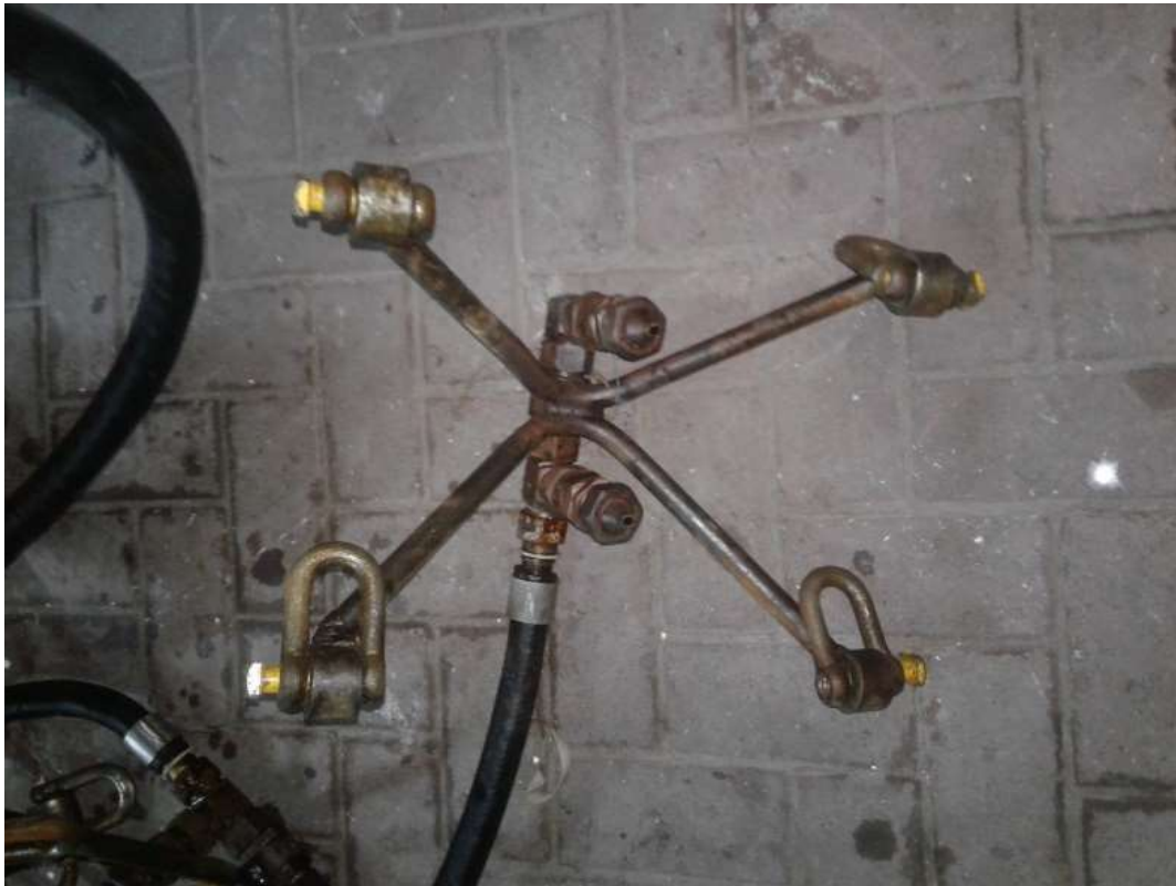
Figuur 54 – Dubbele spuitkop zoals gebruikt tijdens waarnemersreis aan boord van de ARM-33.
