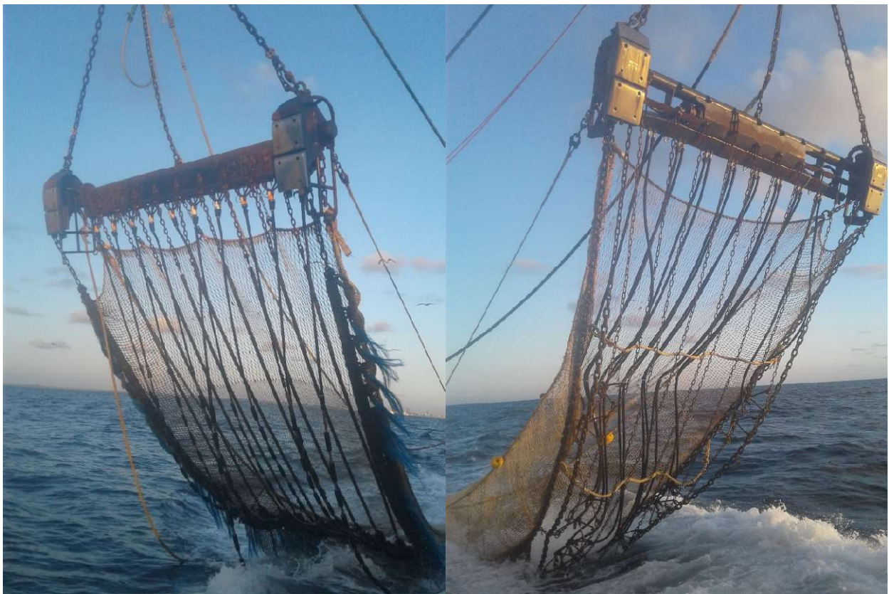
Figuur 53 - Standaard net (puls) op linkerfoto, net met waterjets op rechterfoto.
