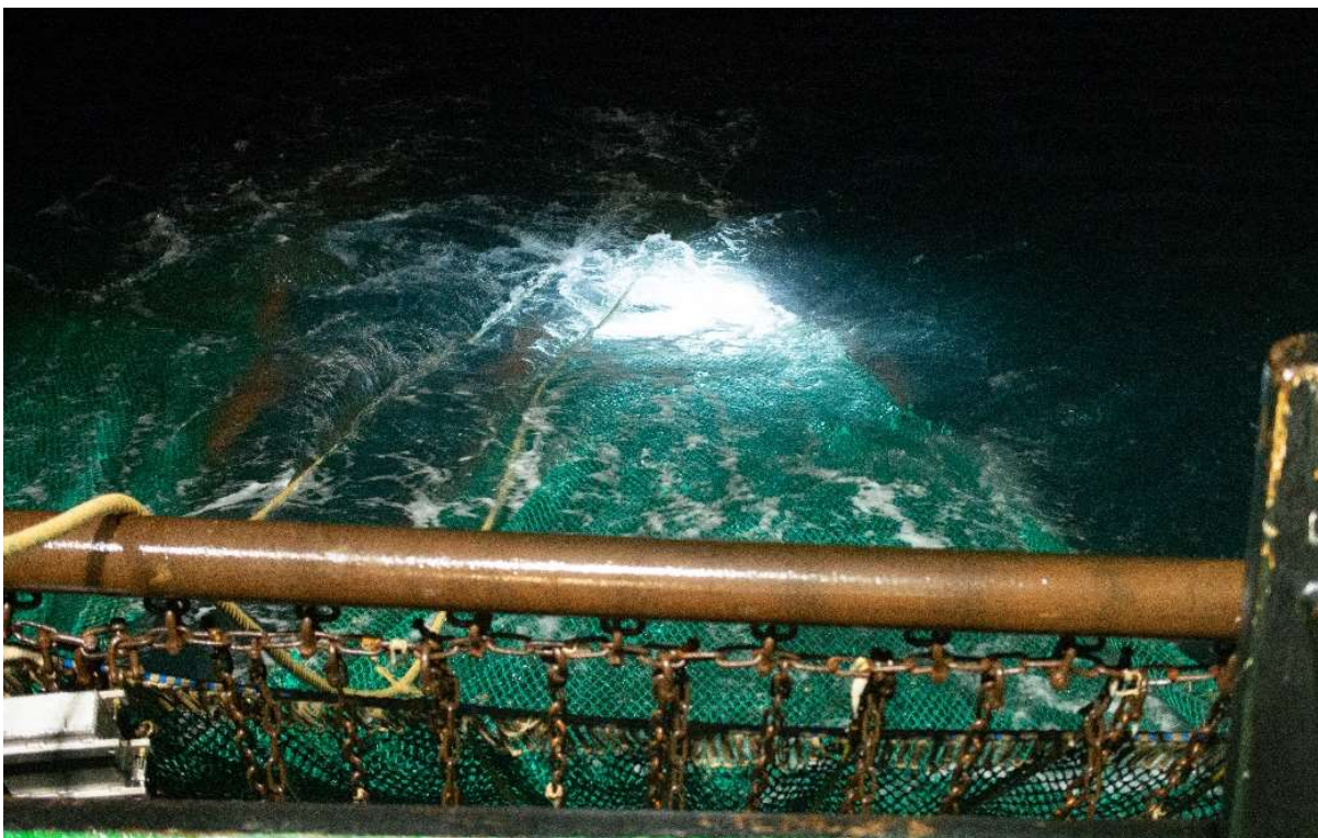
Figuur 27 - Bij het bovenhalen van de netten werd een felle witte gloed waargenomen die het water rond de LED ropes verlicht.
