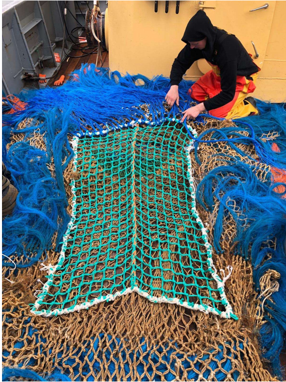
Figuur 41 – Het BRP dat in de buik van het net wordt aangebracht. Bemerkt de blauwe strengen of “spekken” die nu opzij gelegd zijn maar tijdens het vissen de buik van het net beschermen en dus ook grotendeels het BRP overlappen.
