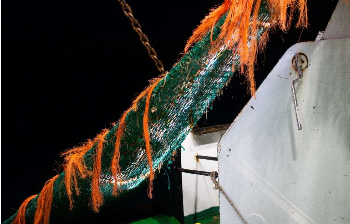
Figuur 26 - Zicht op de plaatsing van de ropes in de buik van het net.
