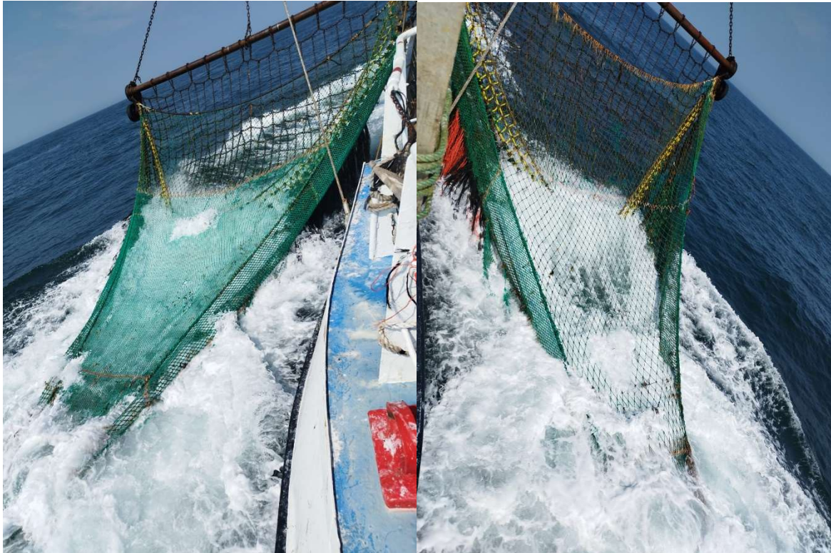
Figuur 3 – Standaard net (links) en experimenteel net met grote mazen (rechts) aan boord van de Z-67 'Rubens'
