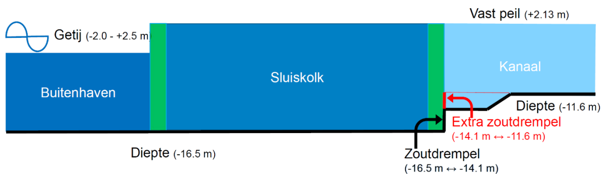
Figuur B-6: Hoogte zoutdrempel en eventuele extra zoutdrempel aan de kanaalzijde van de NST
