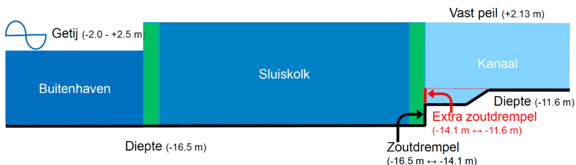
Figuur 2-7: Hoogte zoutdrempel en eventuele extra zoutdrempel aan de kanaalzijde van de NST
