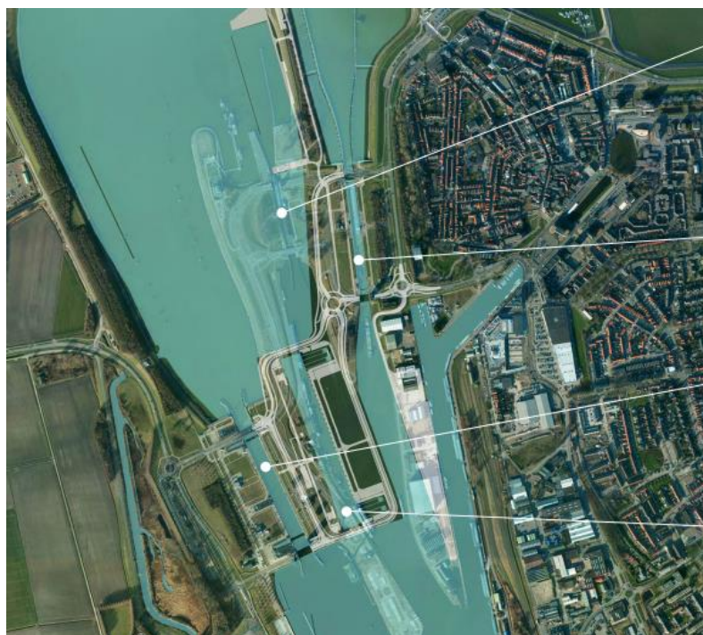
Figuur 1-2 Bovenaanzicht met kentallen Nieuwe Sluis Terneuzen [Brochure Nieuwe Sluis Terneuzen, 2022]. Opmerking: de Westsluis is 13,5 m diep (waterdiepte boven de drempel aan de kanaalzijde).
