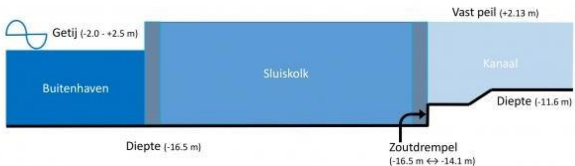
Figuur 2-10: Schematische weergave van Nieuwe Sluis en zoutdrempel (bron: nieuwsluisterneuzen.eu)
