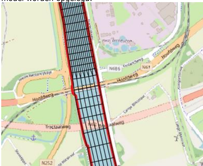
Figuur 2-1: Overgang van het fijne rooster nabij de sluisen naar het grovere rooster in de rest van het KGT.
