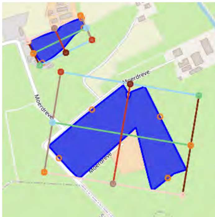
Figuur 31: Tussenresultaat van de methode van Bear voor het bepalen van de dominante gracht en drainagediepte.
