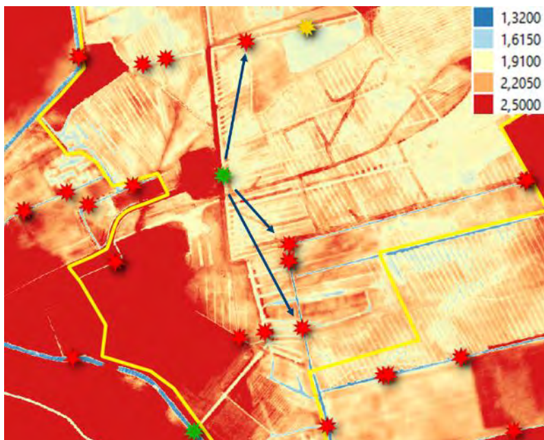
Figuur 32: Illustratie van de vertaling van gesimuleerde oppervlaktewaterpeilen uit het waterbalansmodel naar de waterpeilen in grachten die de drainage van individuele percelen bepalen.
