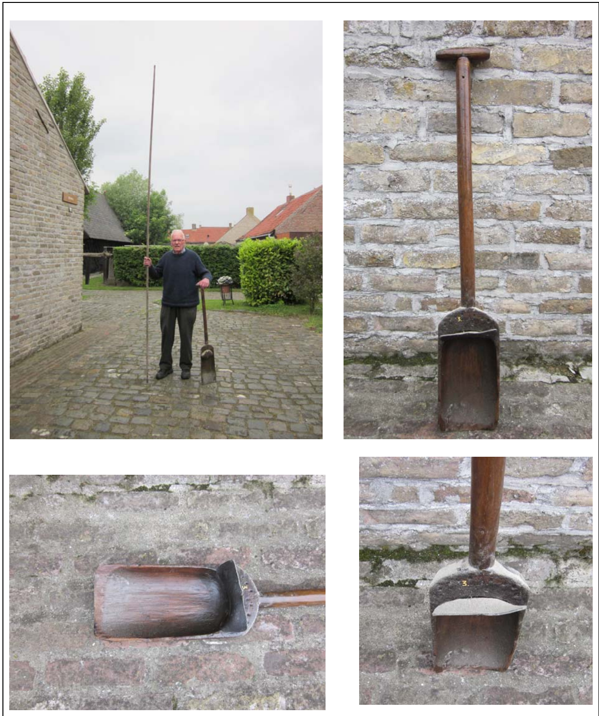
Fig. 7. Marcel Messiaen van het openluchtmuseum “Bachten de Kupe” (Izenberge) met de maatstok, een Veurnse roede (382,5 cm) en een slykschote . Bemerkt de lederen (soms zinken) opstaande rand aan de bovenrand van de schop. Deze rand diende om de modder beter op de schop te kunnen houden (foto's MB).
