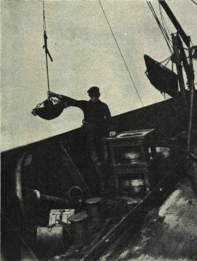
Fig. 17. Der gefüllte Bodengreifer wird eingeholt; auf Deck die Siebe zum Aussieben des Greiferinhaltes.
