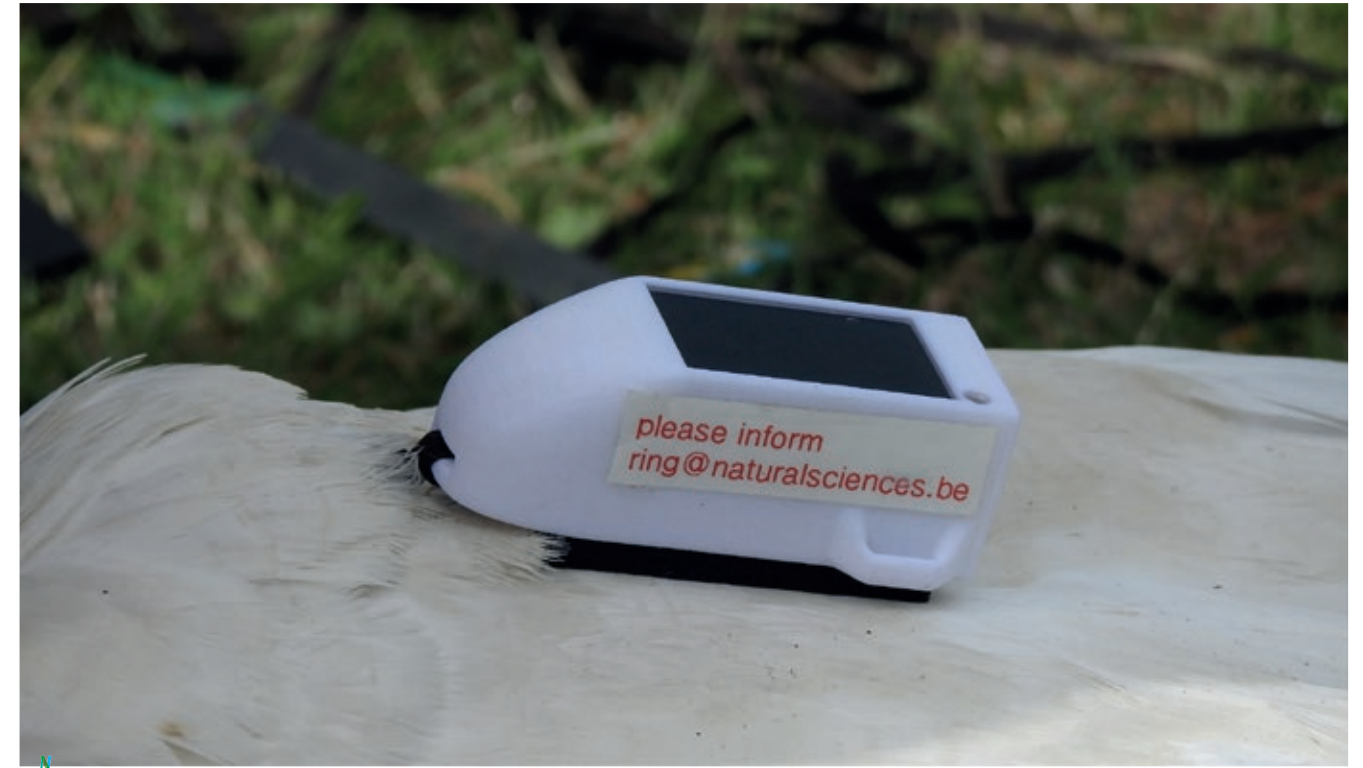
Een zender van het type dat in 2020 werd aangebracht op ooievaars in het Zwin Natuur Park. Met amper 25 gram zijn ze heel licht. Het donkere oppervlak bovenaan zijn de zonnepaneeltjes die voor energie zorgen. Op de zijkant zit een sticker die verwijst naar het Instituut voor Natuurwetenschappen, de partner van het zenderproject in het Zwin Natuur Park. (foto Zwin Natuur Park)
