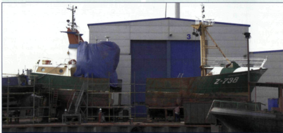
De Z.738 Kariene-Marjanne, bouwjaar 2002, een Belgisch vaartuig uitgebaat door Nederlandse reders, wordt momenteel verlengd bij Scheepswerf Talsma in Franeker in Friesland. (Foto Rienk Nadema)
