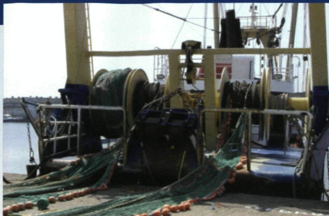
Het twinrigsysteem aan boord van de Z 35 klaar gemaakt te Oostende op 29.07.2002. (foto lvc)
