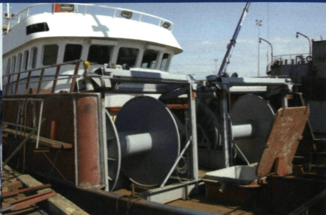
30.06.2011. Het flyshootersysteem wordt voor de brug van de Z 35 geplaatst. De verschansing werd ook gedeeltelijk verhoogd. (foto lvc)
