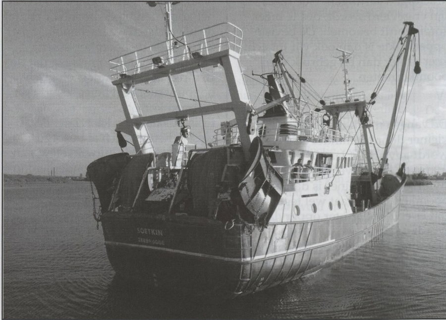
Z.18 Soetkin met aangepast achterschip (nettenrol en scheerborden) voor twinrigvisserij. (foto gw)
