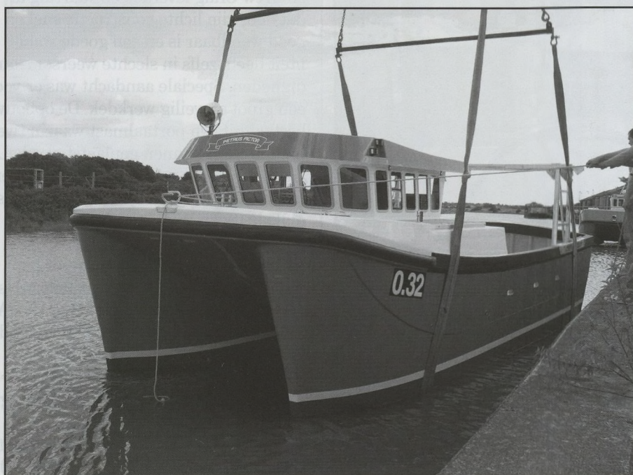
Tewaterlating van het casco voor de O.32 Petrus Pictor in de River Colne te Colchester.
