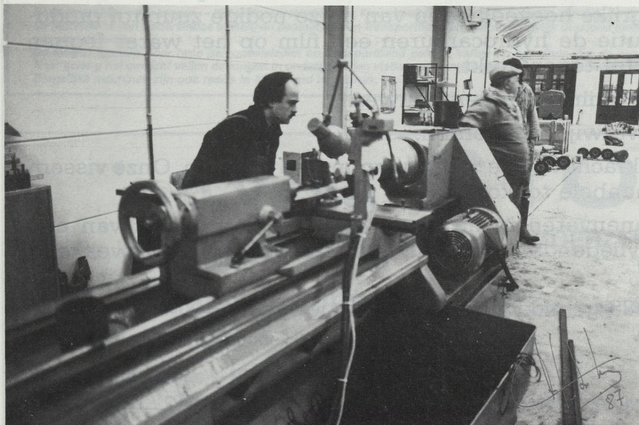
Renaud is druk bezig met het draaien van een nylon hielbus voor de eigenaar van de O.229.
