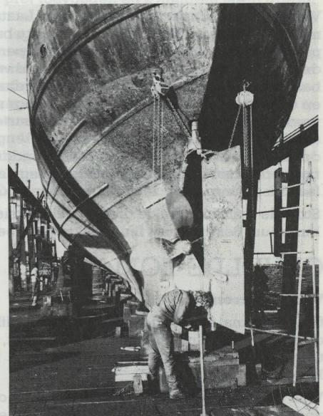
Hier ziet men het vervangen van een nieuwe nylon hielbus aan de O. 229 „Roger-Jeanine” te Oostende.
