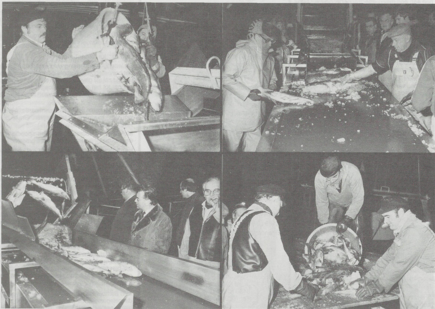
Foto's boven en foto onderaan rechts genomen bij het lossen van de O.206 met de transportband. Deze O.206 kreeg de primeur om als eerste vaartuig gelost te worden met de band. Links onder de vroegere methode van het lossen waarbij de vis op een tafel uitgekipt werd.
