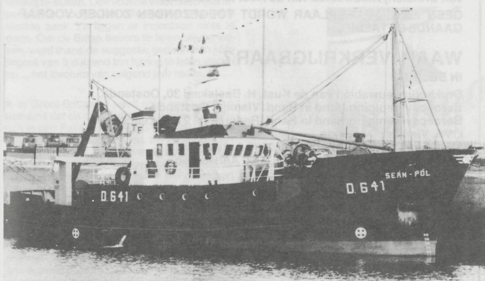
De nieuwe 27-meter lange hekreiler, die zowel voor de pelagische als voor de bodemvisserij ingericht is. Aan boord bevinden zich 3 geïsoleerde tanks voor de bewaring van de pelagische vis in ijsgekoeld water. Er is accommodatie voorzien voor tien personen en zowel de schipper en de stuurman beschikken over een eigen cabine. Men kan anderzijds meer dan duizend bennen vis aan boord nemen (foto: Irish Shipper Dublin).
