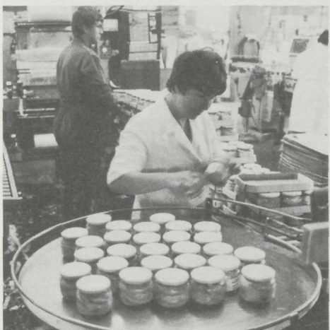
Bovenstaande beelden geven de cyclus weer voor het bereiden van haringfilets. Op de bovenste foto zien wij het vullen van de bokalen; de middenste foto toont aan hoe de potten aangevuld worden met ajunin; het derde beeld toont het eindresultaat. Het is wel zo dat de bokalen die het voorziene gewicht niet halen of overtreffen uitgestoten worden door een ingebouwd mechanisme.
