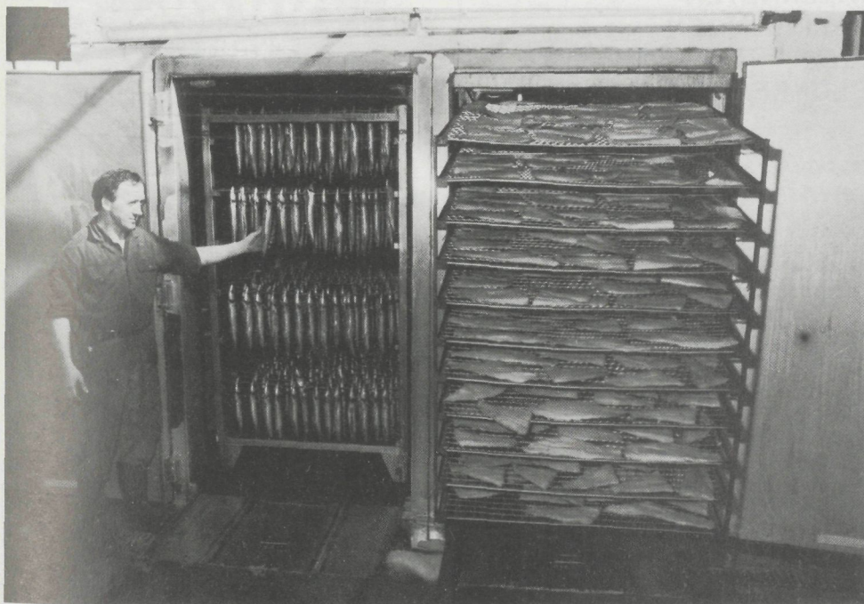
Een gesofistikeerde rookkast waarin diverse vissoorten gerookt worden. Rechts daarvan het bedieningsbord, zegmaar een geperfectioneerde computer waarin de programma's voor het roken worden gestopt. Het kleinste falen van de machine is direct afleesbaar op een speciaal daarvoor voorziene band.
