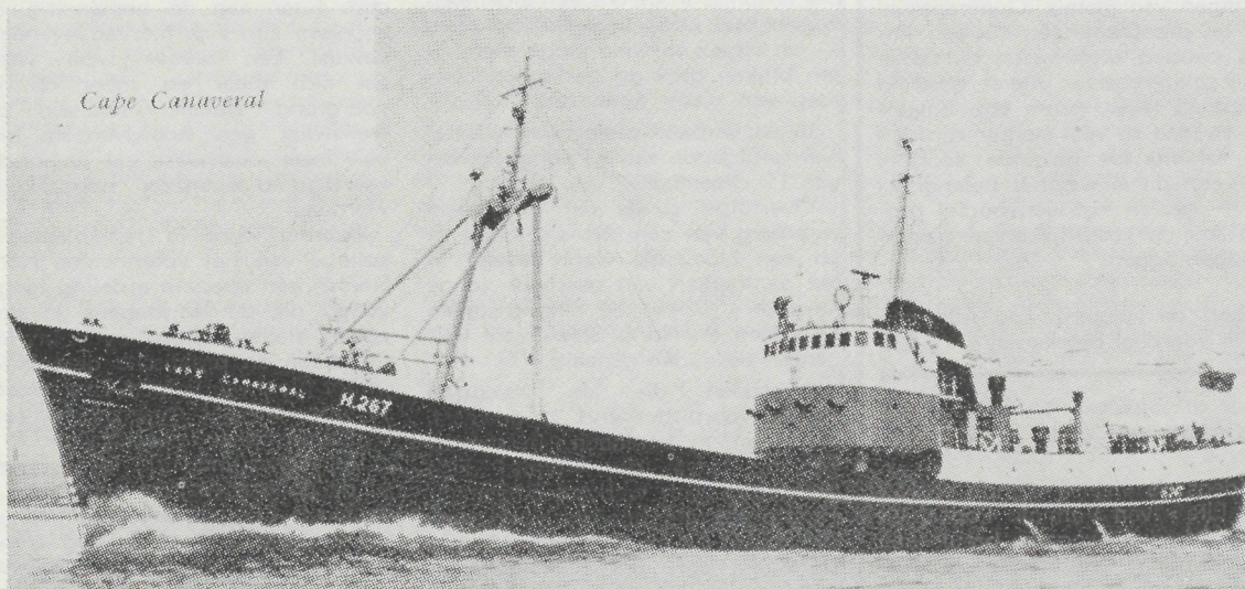
De «Cape Canaveral», een der jongste konventionele diepzeetreilers welke voor de groep Ross gebouwd werd, en vanuit Hull ter visserij uitvaart. De «Cape Canaveral» — 205 voet lang — is de vierde en laatste van een reeks identieke treilers voor de voornoemde maatschappij.
