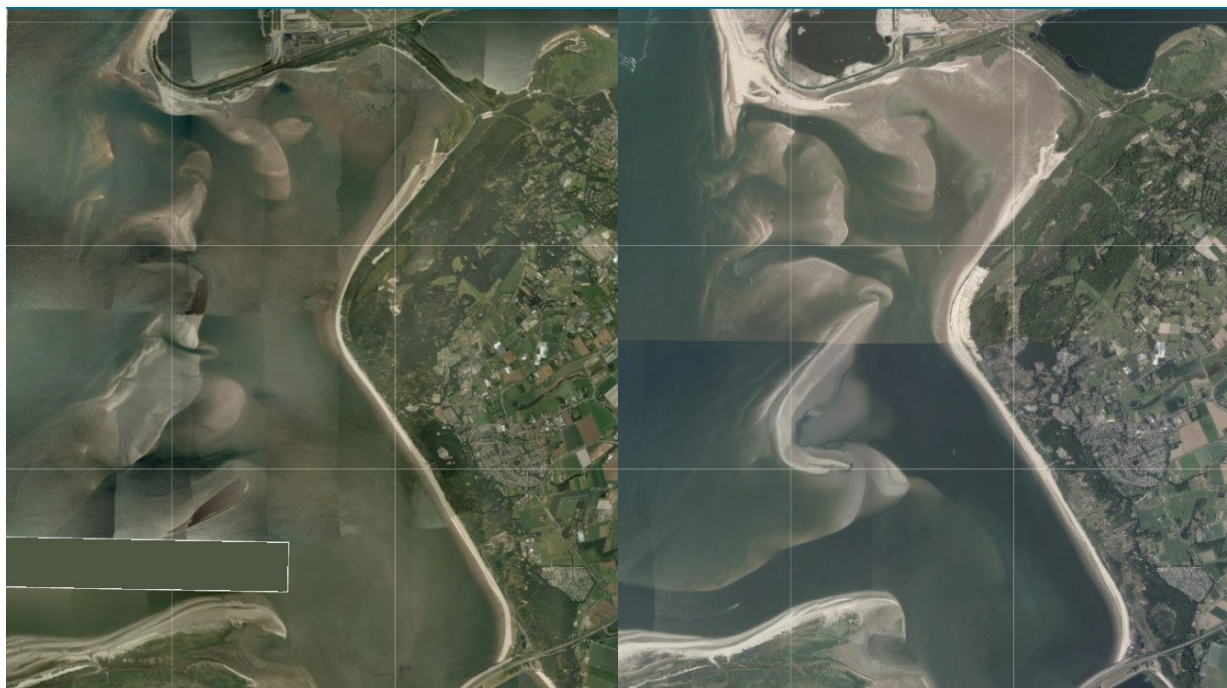
Figuur 3.1. Ontwikkeling van de Hinderplaat voor de kust van Voorne, links 2008, rechts 2019 (Kadaster 2020). Bovenaan is het Slufterdepot op de Maasvlakte zichtbaar, onderaan de Kwade Hoek op Goeree.
